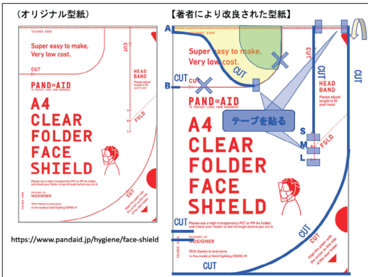
図2：簡易フェイスシールドのオリジナル型紙 (左) と著者による改良型型紙 (右)
